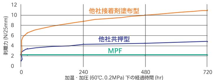
180度剥離力(対 SUS-BA 板)の初期値と、60℃加温・0.2MPa 加圧下の経時値を示します。
